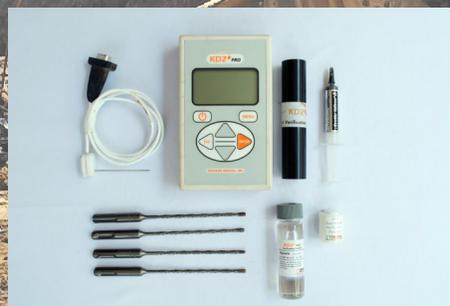
**Medidor de resistividad térmica**
