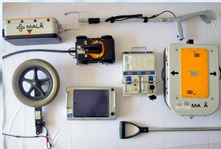
**Radar de penetración terrestre (GPR)**
