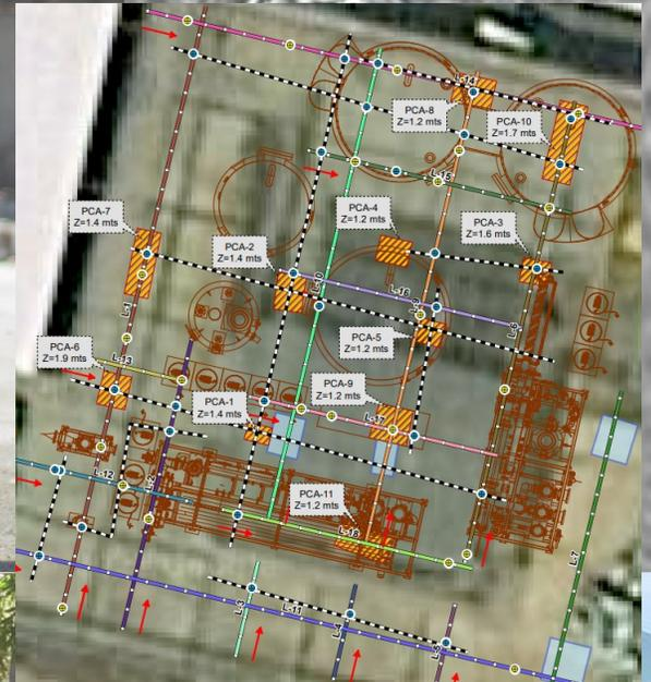
Radargrama donde se observa la distribución de armado metálico, recubrimiento de concreto y remediación de fracturamiento.
