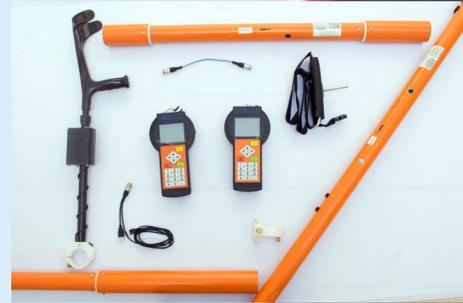
**Radar de penetración terrestre (GPR)**
